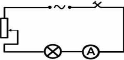
1 / قمنا بانجاز دائرة كهربائية بالتسلسل متكونة من مولد متغير مقاوم متغير , مصباح كهربائي و جهاز أمبير متر كما يبينه الرسم التالي :
