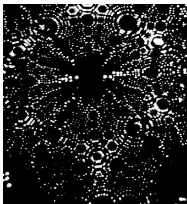
D'autres techniques sont utilisées de nos jours pour voir l'arrangement des atomes dans un métal. Ainsi, avec un microscope à champ ionique, on a pu obtenir une image (fig. 2) agrandie quatre millions de fois d'une pointe de tungstène dirigée perpendiculairement à cette page. Les petites taches de forme sensiblement sphérique indiquent les positions des atomes.
