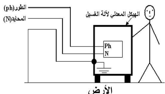
أ- تأمل الرسمين ثم حدد الرسم الذي يتعرض فيه المستعمل إلى صدمة كهربائية إذا حصل تسرب للتيار الكهربائي في الهيكل المعدني لآلة الغسيل معيلا إجابتك؟
