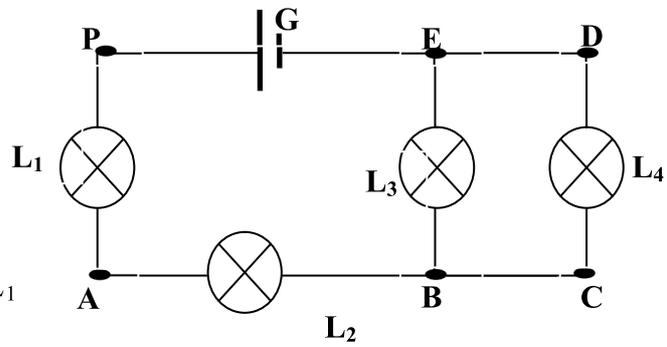
☞ L'intensité du courant qui traverse la lampe  $L_1$  est  $I_1 = 0.7 \text{ A}$
