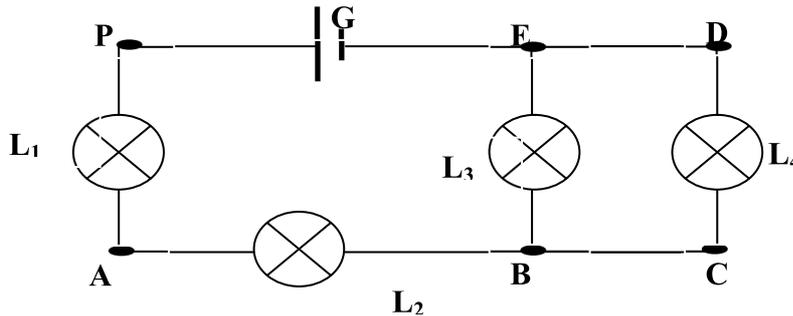
1- représenter sur le schéma le voltmètre pour mesurer la tension aux bornes du générateur  $U_{PE}$
