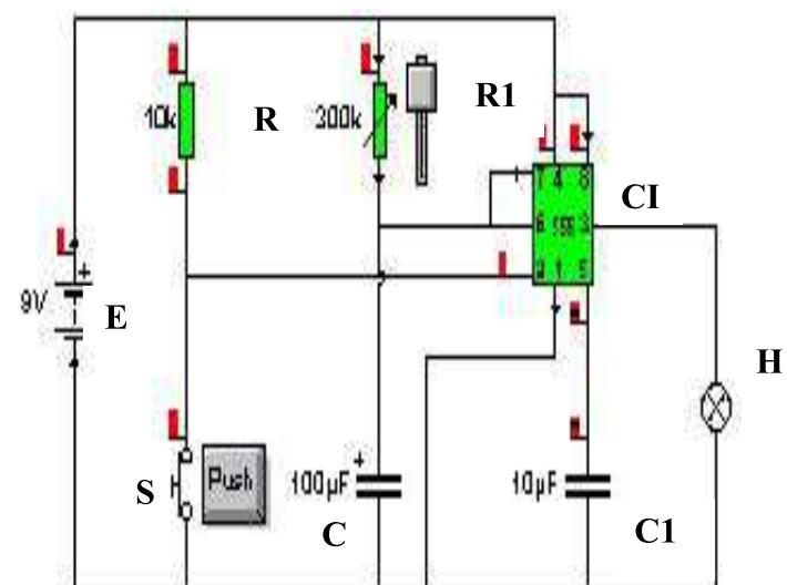
كيف يمكن تغيير قيمة شدة التيار الكهربائي في هذه الدارة؟
