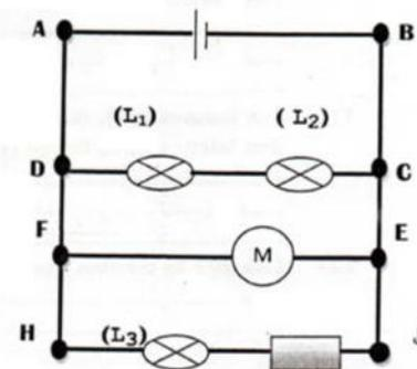
3) On note  $I, I_1, I_2, I_3$  et  $I_4$  les intensités du courant électrique respectivement dénoté par le générateur, traversant la lampe ( $L_1$ ), parcourue dans la branche (DF), traversant le moteur (M) et traversant la lampe ( $L_3$ ). Indiquer le sens du courant électrique dans chaque branche de ce circuit.
