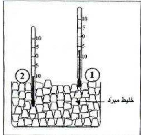
3/ il met dans chaque tube un thermomètre puis il le place au même instant  $t = 0$  min dans le mélange réfrigérant alors il obtient les résultats résumés aux croquis suivants à différents moments :
