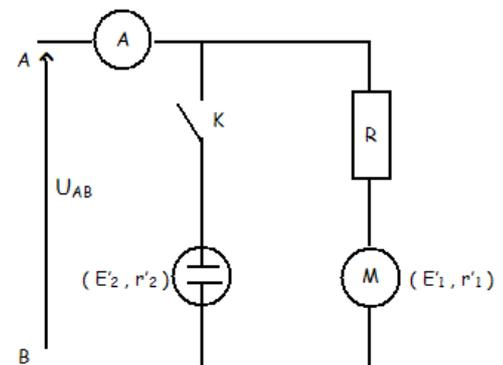
( A - 0,5 ) 3-Lorsque K est ouvert et le moteur tourne librement, l'ampèremètre indique une intensité  $I_2 = 0,2 \text{ A}$ . Déterminer la fém  $E_1'$  du moteur.
