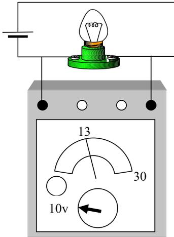
4- لاحظ المعطيات على جهاز القياس وحدد قيمة الجهد الكهربائي بين طرفي المصباح .
